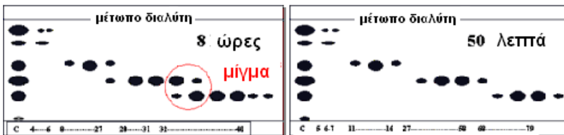
Σχήμα 10. Διαχωρισμός με απλή χρωματογραφία στήλης (αριστερά) και φλάς (δεξιά)
