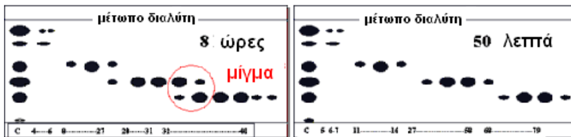
Σχήμα 10. Διαχωρισμός με απλή χρωματογραφία στήλης (αριστερά) και φλάς (δεξιά)
