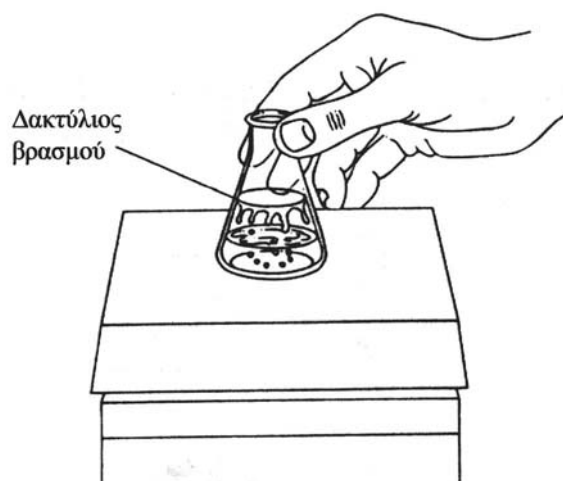
Εικόνα 1.32 Προσεκτική θέρμανση σε βρασμό υγρού σε κωνική φιάλη
