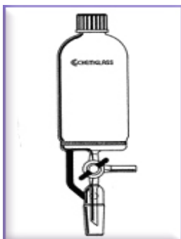
Εικόνα. Δοχείο σύνθεσης πεπτιδίων σε στερεή φάση.
